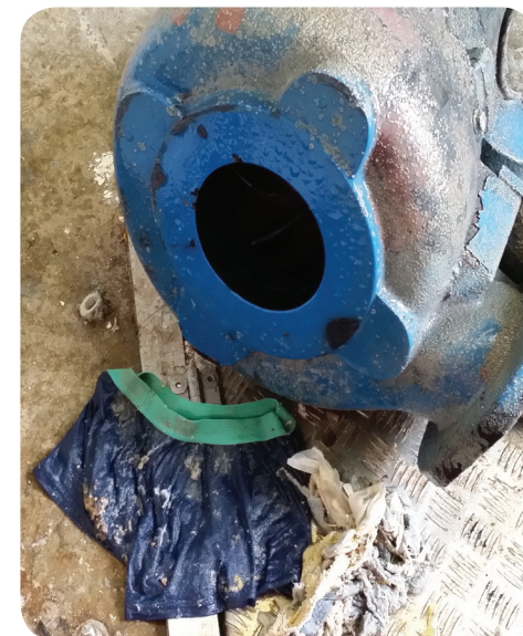
En stoppet spildevandspumpe fyldt med engangsklude og hår. ▼
