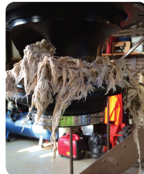
En stoppet spildevandspumpe fyldt med engangsklude og hår. ▼
